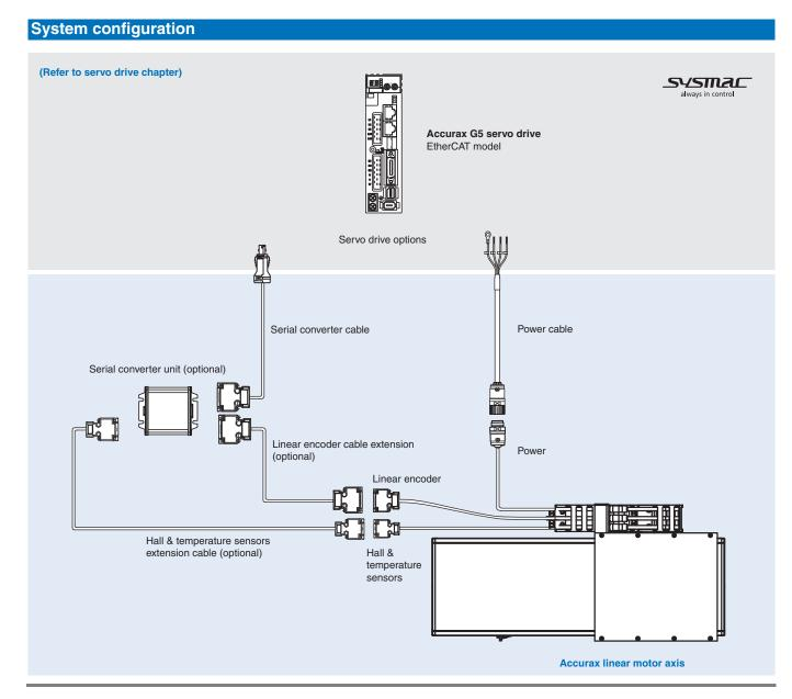
Accurax linear motor axis 271
