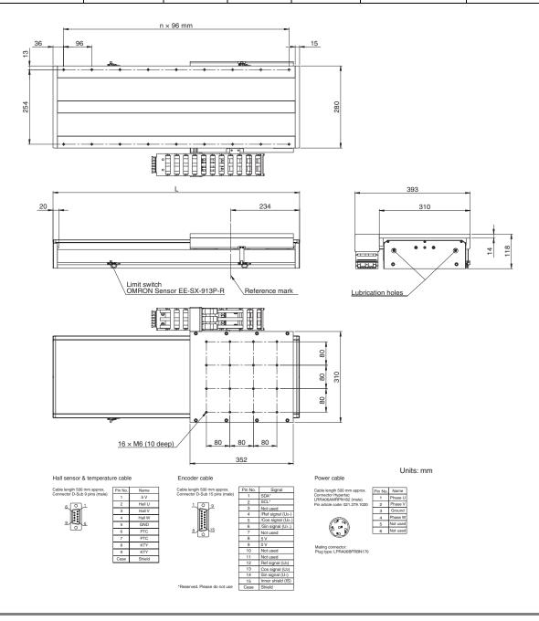
Accurax linear motor axis 281
